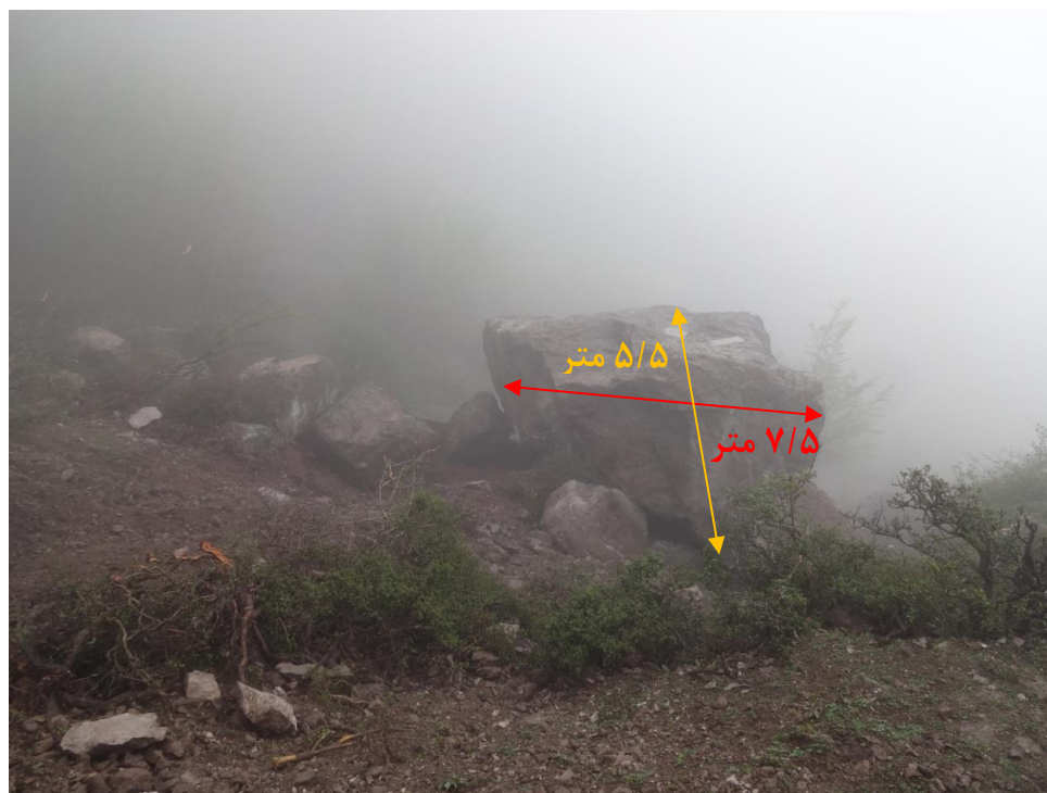
شکل-۵- بلوک های سنگی متوقف شده در ارتفاعات مشرف به روستا آماده حرکت مجدد
